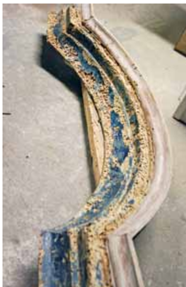
Po zdjęciu farby widoczne zniszczenia drewna przez drewnojady
